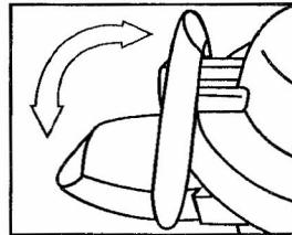
Setzen Sie den Deckel mit den Verriegelungsnasen in der richtigen Position wie in der Abbildung gezeigt auf und schließen Sie dann Kocher
